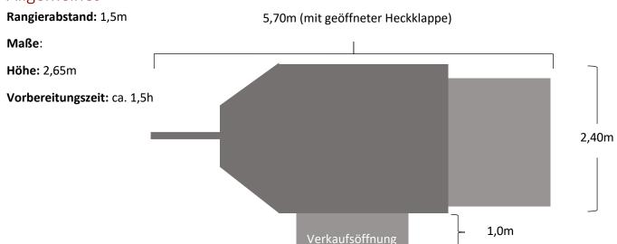
Gewicht: ca. 2,5t verteilt auf 2 Achsen, sowie Stützen
